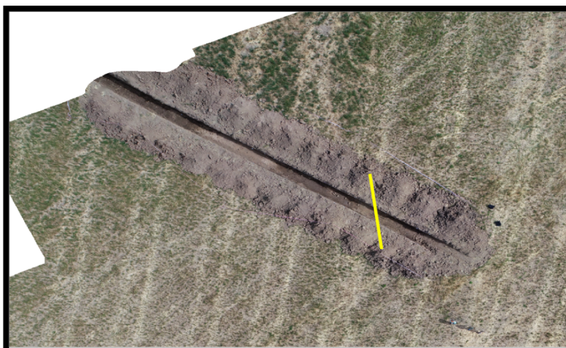
Figura 4:7 - Marcação, a amarelo, do azimute real da falha detectada no terreno.
